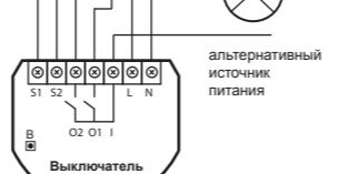
Рис.1 Электрическая схема для подключения
